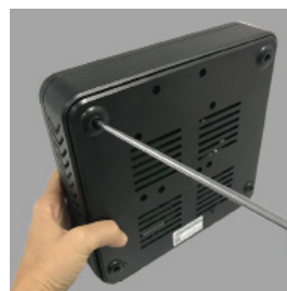
08 - Parafuse a tampa, finalizando a instalação
