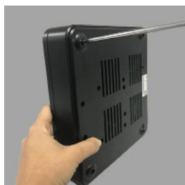
01 - Retire os parafusos da tampa
