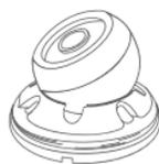
5. Pressione o anel menor juntamente com a cúpula da câmera forçando para baixo.
