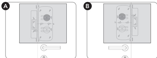
**!** Antes de realizar os furos, simule o posicionamento da parte interna e do batente e certifique-se de que ambas estão alinhadas conforme a imagem ao lado.
