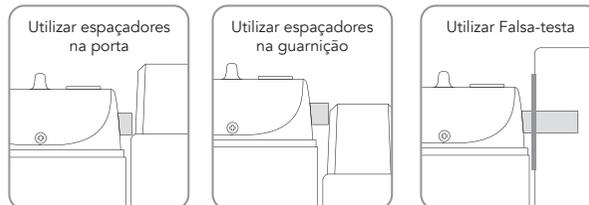
**!** Confirme que o trinco estará centralizado (vertical e horizontalmente) no batente. **O trinco não deve encostar ou raspar no batente para a correta operação do produto.**
