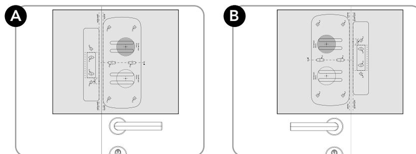
⚠ Antes de realizar os furos, simule o posicionamento da parte interna e do batente e certifique-se de que ambas as peças estão alinhadas como na figura abaixo.
