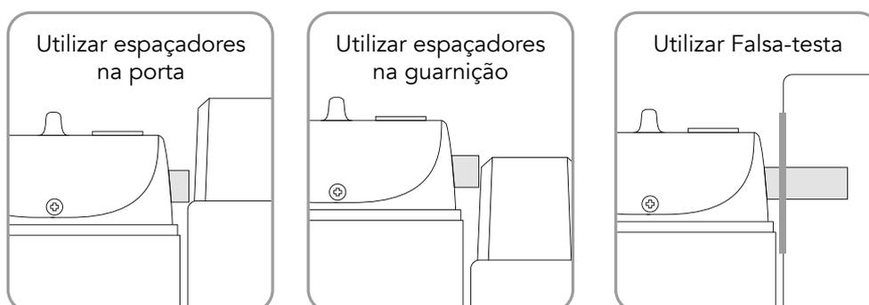
⚠ Confirme que o trinco estará centralizado (verticalmente e horizontalmente) no batente. O trinco não deve encostar ou raspar no batente para a correta operação da iDLock.
