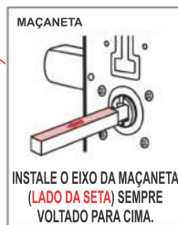
Passo 4 Instale a parte traseira da fechadura
