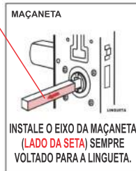
Passo 4 Instale a parte traseira da fechadura
