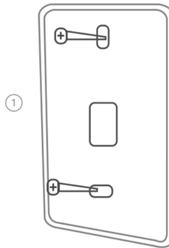
1 Fixação da tampa traseira na parede.
