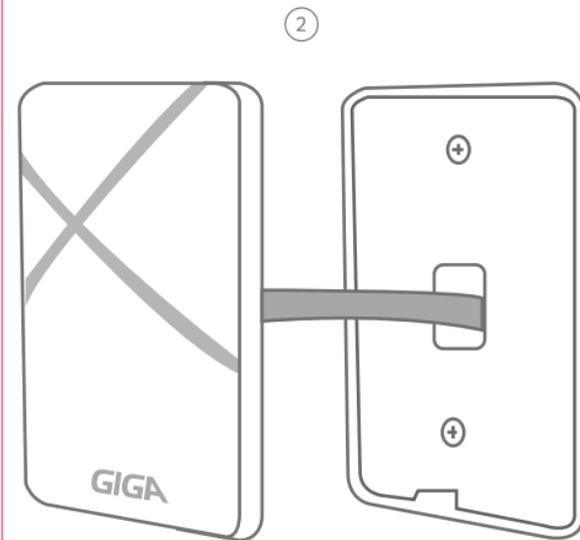
2 Passagem dos fios pela tampa traseira e depois fixação do equipamento.
