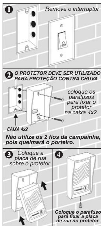
Figura 20 - Fixando a placa de rua
