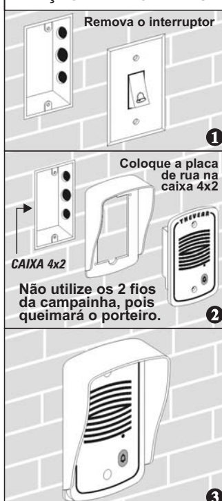
Figura 11 - Fixando a placa de rua
