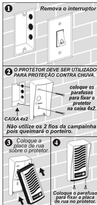
Figura 22 - Fixando a placa de rua
