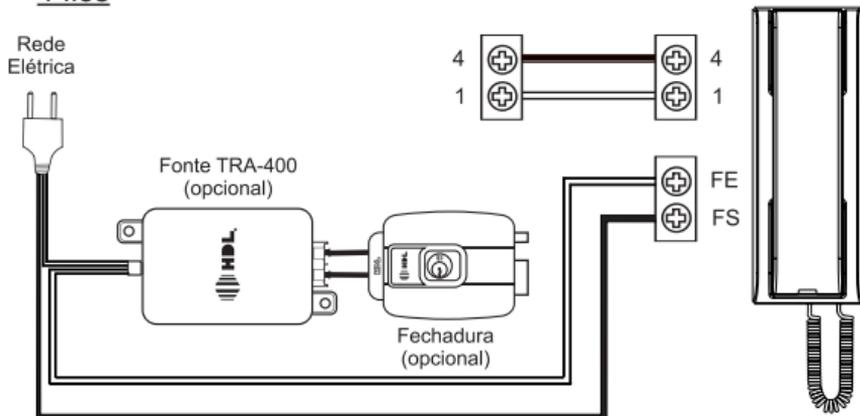
A instalação a quatro fios é recomendada como forma de aumentar a segurança da instalação, visto que um dos fios da fechadura passa pelo interfone.
