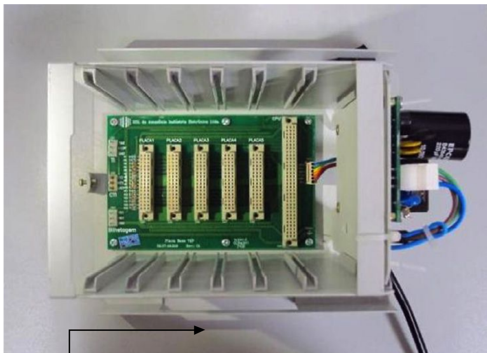
Sentido de orientação para inserir as placas
